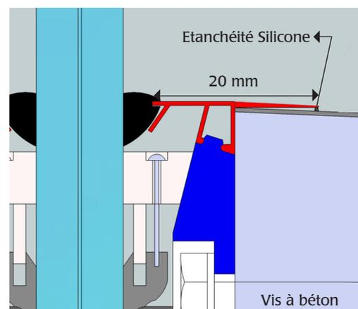
*La couvertine se clipse sur le profil et permet une finition plus soignée par recouvrement sur le sol fini.*
