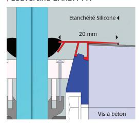
La couvertine se clipse sur le profil et permet une finition plus soignée par recouvrement sur le sol fini.
