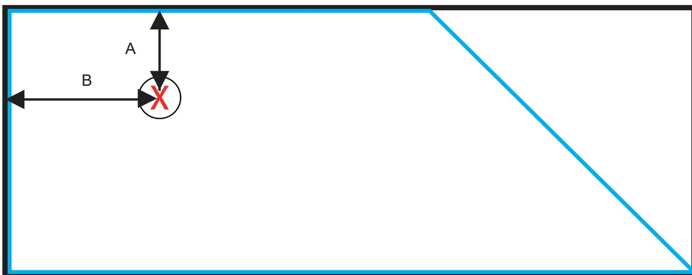
*Kreuzen sie Sie einfach an, wo Sie Bohrungen haben wollen und geben Sie die Entfernung zwischen der Kante des Glases und der Bohrung an.*
